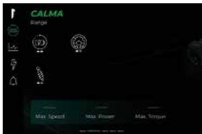
Ce mode de conduite est conçu pour une conduite efficace et optimisée en termes de consommation d'énergie. Il s'agit du mode de conduite par défaut au démarrage du véhicule.
