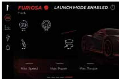
Ce mode de conduite est conçu pour la conduite sur circuit dans des conditions d'adhérence élevées. L'aide au départ (Launch Control) n'est disponible que dans ce mode, pour obtenir des performances maximales.
