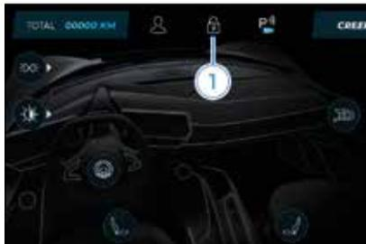
Le verrouillage/déverrouillage de l'écran de l'assistant automobile permet de verrouiller/déverrouiller la porte du conducteur et du passager en touchant l'icône cadenas 3 correspondante, de déverrouiller le port de charge en touchant l'icône éclair/cadenas 2 ou de verrouiller simultanément toutes les portes en touchant l'icône 1.
