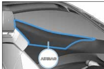
**⚠️ AVERTISSEMENT :** n'appliquez pas d'adhésifs ou d'autres objets sur le volant, sur la planche dans la zone latérale de l'airbag passager, sur les revêtements latéraux du toit ou sur celui intérieur de la porte. Ne mettez jamais d'objets (comme par exemple des téléphones portables) dans la poche latérale de la planche côté passager car cela pourrait entraver le gonflage de l'airbag du passager et provoquer de graves blessures aux passagers.
