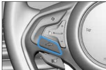
La Battista est équipée d'un système de suspensions hydrauliques qui est utilisé pour relever l'avant et l'arrière de la voiture lorsqu'elle entre dans une allée abrupte ou franchit des ralentisseurs.
