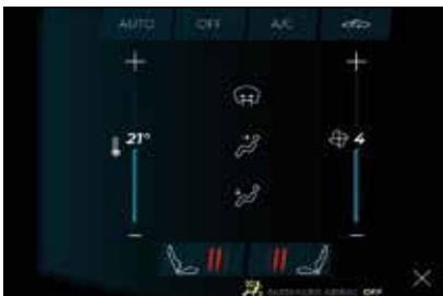
préférences, accédez aux paramètres des commandes de chauffage-climatisation à partir du menu principal de l'écran de droite en touchant le bouton de température 1 situé en bas à droite de l'écran.
