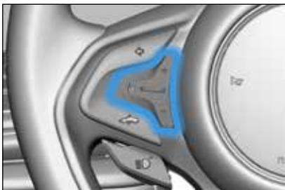
Le régulateur de vitesse (Cruise Control) est un système d'aide à la conduite à commande électronique qui permet de maintenir la vitesse souhaitée de la voiture, sans avoir à appuyer sur la pédale d'accélérateur. Ce dispositif peut être utilisé à une vitesse supérieure à 30km/h sur de longs tronçons de routes sèches, rectilignes et présentant peu de variations (par exemple, les autoroutes).
