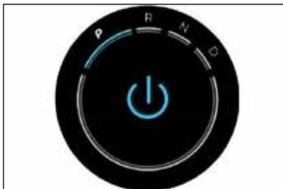
Le pommeau du sélecteur de vitesses est équipé d'un commutateur rotatif et d'un bouton.
